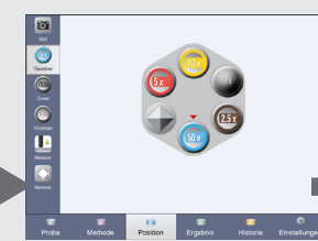
Der Revolver zeigt das aktuell eingeschwenkte Objektiv bzw. Eindringkörper
