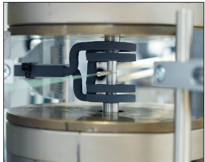
Induktionsheizsystem und aktive Luftkühlung
