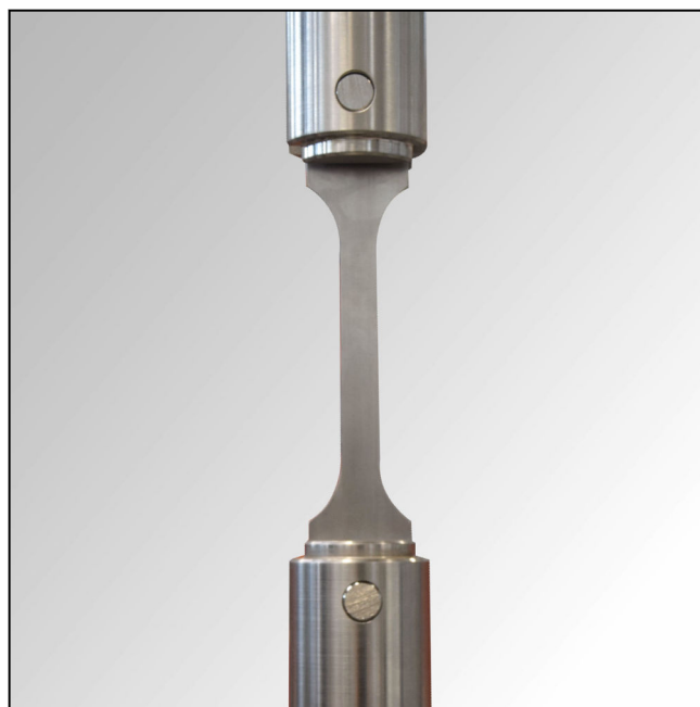
Hochtemperatur-Probenadapter für Flachproben mit Schulterkopf und Bohrung
