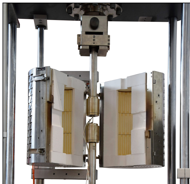
Hochtemperatur-Zuggestänge und Hochtemperatur-Ofen in Kappa SS
