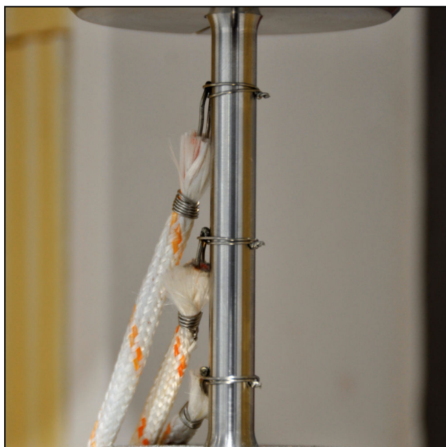
Hochtemperatur-Probenadapter für Rundproben mit Gewindekopf und Thermoelementen
