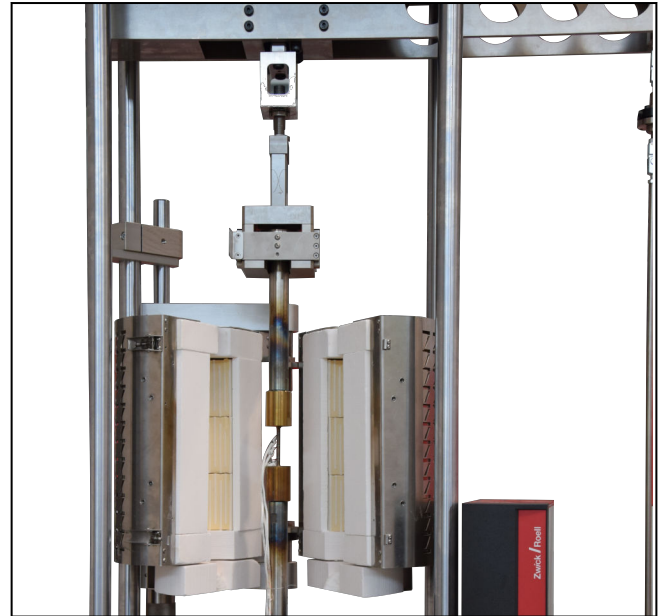
Laststrang und Zuggestängeaufnahme in Zeitstandprüfmaschine Kappa LA
