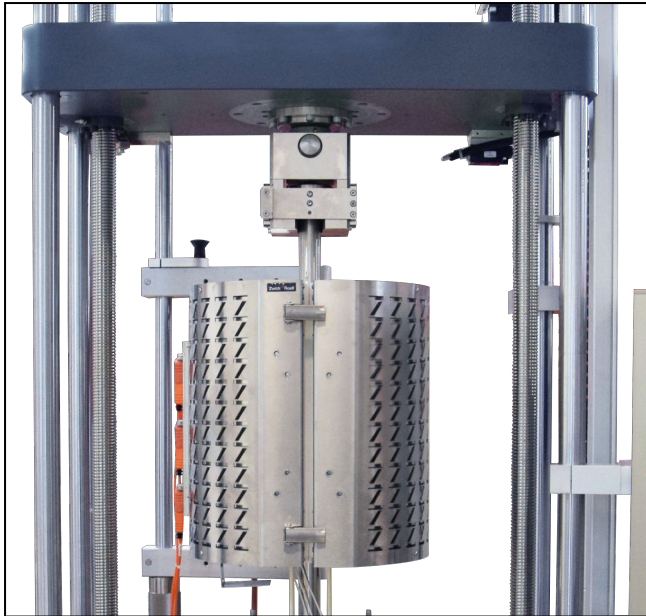
Laststrang und Zuggestängeaufnahme in Zeitstandprüfmaschine Kappa DS
